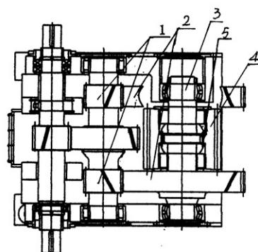
1. 单边双传动减速机，其特征在于：该减速机为三级齿轮传动，其特征在于：第一级为斜齿轮传动；第二级为两端不相等螺旋角人字齿轴（1）驱动两件第二级大齿轮（2）；第三级的输入端为第二级两大齿轮（2）带动的两件传动轴（3）与两小件齿轮（4），两件小齿轮（4）驱动大齿圈（6）。
