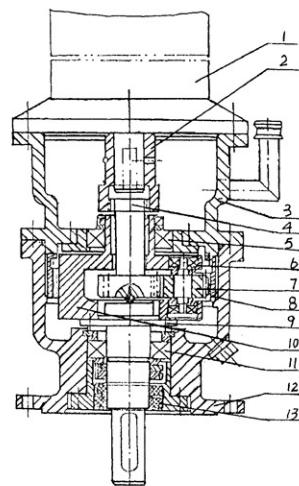
1、一种釜用减速机行星传动机构，包括有螺栓穿过上箱体（3）的下端面法兰盘的孔与下箱体（12）上端面内螺纹啮合，螺栓穿过电机（1）法兰盘的孔与上箱体（3）连接座内螺纹啮合，其特征是电机（1）的输出轴轴上套有连接齿套（2）一端，连接齿套（2）的另一端内齿轮与双联齿轮（4）的小齿啮合，双联齿轮（4）的大齿与行星齿轮（7）啮合，行星齿轮（7）与固定在下箱体（12）箱内内齿圈（8）啮合，行星齿轮（7）两端轴上装配有行星架轴承（6），行星架轴承（6）装在行星架（10）上，行星架（10）上部外圆套有上轴承（5），螺栓穿过主轴（9）法兰盘的孔与行星架（10）下端面内螺纹啮合，主轴（9）与下箱体（12）之间轴上依次装配有轴承（11）和油封（13）。
