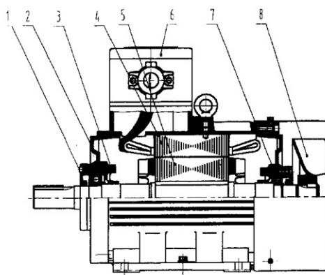
1、一种隔爆型永磁三相同步电动机，它包括：轴承外盖、端盖、轴承内盖、定子、转子、接线盒、轴承、风扇构成，其特征在于：轴承外盖通过螺栓与端盖、轴承内盖相连接，轴承外盖通过螺栓与定子相连接，并有隔爆接合面。
