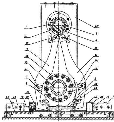
1、一种换向减速机包括壳体，换向装置，主动轮，被动轮，输出轴，输入轴，其特征在上述所述的输入轴（1）上固定偏心轮（2），偏心轮（2）外圆上有偏心轴承（3），偏心轮轴承（3）外圆上有拉板套（4），拉板套（4）上分别铰连左拉板（5）、右拉板（6）；左拉板（5）上铰连左拉钩（7），左拉钩（7）上固定左拉钩导块（9）；用左拉钩导块销（11）与左拉板（5）铰连；在右拉板（6）上铰连右拉钩（8），右拉钩（8）上固定右拉钩导块（10）用右拉钩导块销（12）与右拉板（6）铰连，在输出轴（13）上固定套筒滚子轮（14），在底板（26）上固定左程控液力缸（15）、右程控液力缸（16），左拉板导板（21），右拉板导板（22）；在左程控液力缸（15）内装左柱塞（17），用左拉板锁定器（19）与左拉板导板（21）连接，在右程控液力缸（16）内装有右柱塞（18），用右拉板锁定器（20）与右拉板导板（22）连接，解锁弹簧（24）套在推杆（23）上，拉板套（4）两侧设置有左限位板（27），右限位板（28）。
