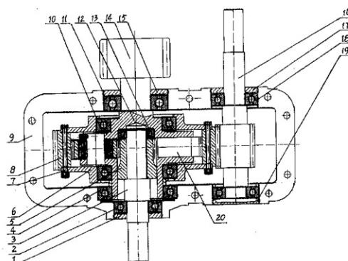
1. 一种绞车差动减速机，由电机输入轴、太阳轮轴、太阳轮、齿圈、行星轮、行星架、行星端盖、外齿轮、箱体、轴承和油封组成，其特征在于：在箱体（9）上通过轴承（18）安装电机输入轴（16），通过轴承（2）安装太阳轮轴（3），通过轴承（4）（11）安装行星架（12），在行星架（12）上通过轴承（13）安装太阳轮轴（3），通过轴承（10）安装行星端盖（6），齿圈（8）通过螺栓（7）安装在行星端盖（6）上，电机输入轴（16）上的齿轮与齿圈（8）啮合，行星轮（20）与齿圈（8）的内齿轮和太阳轮（5）啮合，行星轮（20）与行星架（12）相连。
