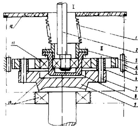
1、一种全密封行星减速机，包括输入轴、输出轴、激发器、轴承、行星轮、中心轮，其特征在于减速机设有柔性密封装置、平衡装置、过渡轴承，输入轴为设有附轴的曲轴，附轴上设置单片行星轮，在输入轴上的附轴对面设置平衡装置，过渡轴承设置在激发器与行星轮之间，柔性密封装置的上部、下部分别与法兰和激发器的透盖连接。
