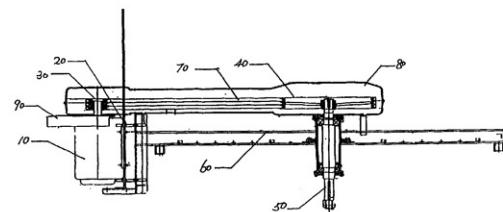
1、一种设有皮带箱的减速机，主要是由马达、皮带轮、减速机主轴和皮带组成，其特征在于：两皮带轮外设有皮带箱，皮带箱分上、下盖，上、下盖之间通过上盖吊钩和下盖扣环相连。
