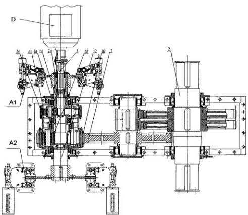
1. 行星变速双速减速器，其特征在于，包括原动机(D)、制动器(A1)、制动器(A2)、输入轴(3)、输出轴(2)、平行轴(1)、第一级行星传动机构、第二级行星传动机构，所述的第一级行星传动机构包括太阳轮(Za1)、内齿圈(Zb1)、行星轮(Zc1)、行星架(H1)，所述的第二级行星传动机构包括太阳轮(Za2)、内齿圈(Zb2)、行星轮(Zc2)、行星架(H2)，所述的第一、第二级行星传动机构与包括制动器在内的部件相配合构成行星变速双速减速器。
