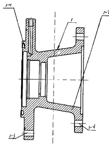
1、一种行星摆线针轮减速机的法兰接盘，其特征在于：法兰接盘（1）是由电机接盘和法兰盘构成的一体结构，前半部分（1-1）的内部结构和尺寸与相应的减速机针齿壳相配合安装的法兰盘相同，内腔为阶梯式，前半部分（1-1）外端面上设有安装的通孔（1-3）；后半部分（1-2）为普通电机接盘与电机配合的结构，内腔为梯形式，后半部分（1-2）的外端面上开有安装通孔（1-4）。
