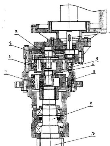
1 一种行星齿轮减速机，其由外啮合齿轮装置、二级行星减速装置、输出齿轮轴和传动齿轮等部件构成，其特征在于二级行星减速装置包括相同两套行星齿轮装置，每套行星齿轮装置由传动太阳轮、传动行星轮和传动行星支架构成，其中传动太阳轮与三个传动行星轮相啮合，传动行星轮与传动行星支架的内齿圈相啮合，二级传动行星支架与三级传动太阳轮之间通过内花键将两套行星齿轮装置连成一体，三级传动行星架通过内花键与输出齿轮轴连接。
