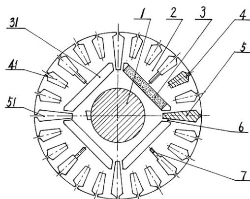
1. 一种新型自起动永磁同步电动机，包括机座及组装其内的定子，由转轴（1）、铁芯（2）、磁钢（3）、鼠笼导条（4）和（5）构成的转子，其特征在于内置式径向分布的磁钢（3），轴向装入转子铁芯（2）的磁钢槽（31）内，磁钢槽（31）位于鼠笼导条槽（41）的下方；而鼠笼导条槽（51）位于各磁钢槽相邻极间的对称轴线上，形成多对极间隔磁桥（6）；控制槽（7）位于磁钢槽（31）的对称轴线上；所述铁芯（2）的转子冲片为一整体结构。
