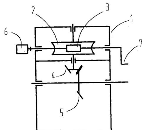
1、一种用于角行程电动执行器的减速机，包括一个箱体（1）、一个装在箱体上的电机（6）和由该电机驱动的装在箱体内的减速机构，其特征是所说的电机是转速小于100转/分的低速电机（6），所说的减速机构由第一级的蜗轮（2）、蜗杆（3）减速机构和第二级的锥齿轮（4、5）减速机构组成。
