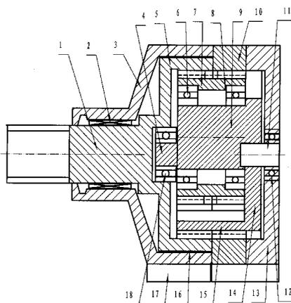
1. 一种减速机包括外壳、齿轮、输出轴，其特征在于：电动机压盖与环形内齿轮、外壳、固定底座固定连接，压盖外侧中心有动力输入轴承，由平衡体圆轴、圆弧状平衡块、平衡体底板组成的平衡体，平衡体底板上有与圆弧状平衡块同心的动力输入轴孔，平衡体圆轴另一端有与动力输入轴孔同心的平衡块凸轴，平衡体圆轴上用轴承安装着双联齿轮，双联齿轮的右齿轮与环形内齿轮啮合，与输出轴一体的输出内齿轮与双联齿轮之左轮相啮合，安装在外壳内，输出内齿轮与外壳间装有聚四氟滑动轴承，输出内齿轮侧壁中心孔内装有平衡体凸轴和凸轴轴承，输出轴与外壳间装有输出轴承。
