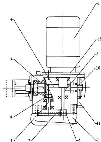
1、整传动比齿轮减速机，包括电机（1）、机座（2）、输入轴（3）、输出轴（4）和齿轮传动机构，其特征在于还设有中间轴（5），输入轴（3）与输出轴（4）相互垂直设置，中间轴（5）与输入轴（3）相互平行设置，中间轴（5）一端与输入轴（3）之间设有主动齿轮（6）和被动齿轮（7）传动连接，中间轴（5）另一端与输出轴（4）之间设有主动锥齿轮（8）和从动锥齿轮（9）传动连接，主动齿轮（6）和被动齿轮（7）及主动锥齿轮（8）和从动锥齿轮（9）之间的传动比的乘积为整数。
